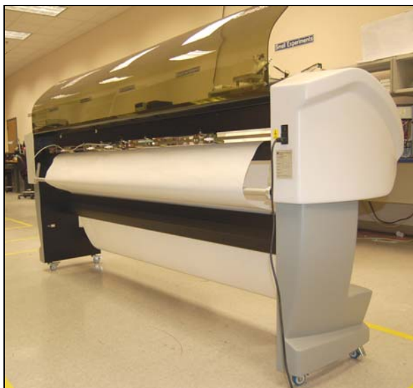
Figura 18. Papel alimentado a través de la barra de presión y los rodillos de arrastre
