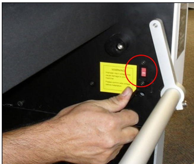
Figura 13. Conmutador de tensión
