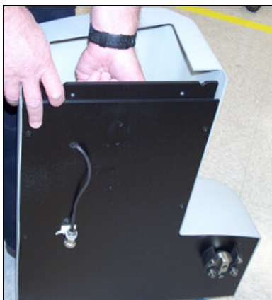
Figura 7. Columna lateral derecha fuera de la caja y equilibrada
