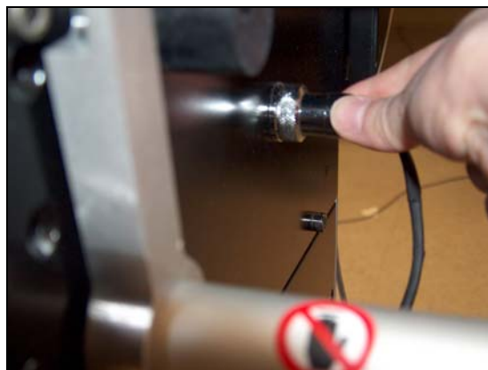
Figura 10. Cable del motor de alimentación (dentro de la columna lateral derecha)
