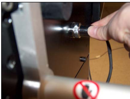
图 10. 位于右侧支撑架上的送纸轴马达电缆
